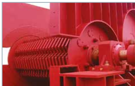
Trituratore di canne da zucchero Paralleli e ortogonali serie G
