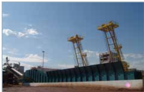
Scaricatore di canne da zucchero Paralleli e ortogonali serie G e H
