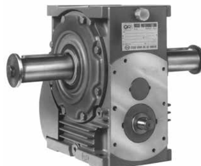
Reductor ejecución UO2B: extremo de sinfín reducido (sirve también para obtener R IV, MR IV, MR 2IV, MR V 160 ... 250 con acoplamiento). Árbol lento de doble salida.
