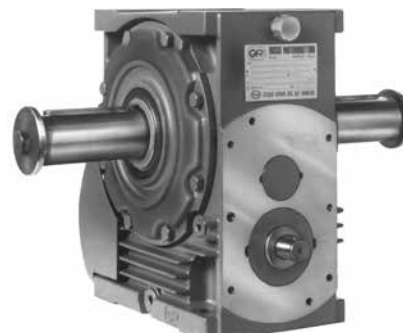
Redutor em execução UO2B: extremidade da rosca de sem fim reduzida (útil para obter R IV, MR IV, MR 2IV, MR V 160 ... 250 com junta). Eixo lento bi-saliente.
