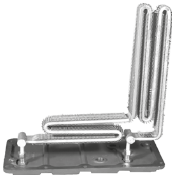
Echangeur de chaleur intérieur, sur le capot d'inspection du réducteur
