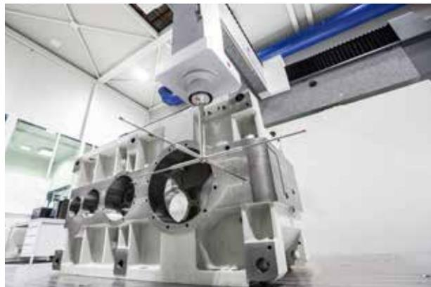
Carcaça de duas metades em ferro fundido esferoidal (UNI ISO 1083) com nervuras de reforço.
